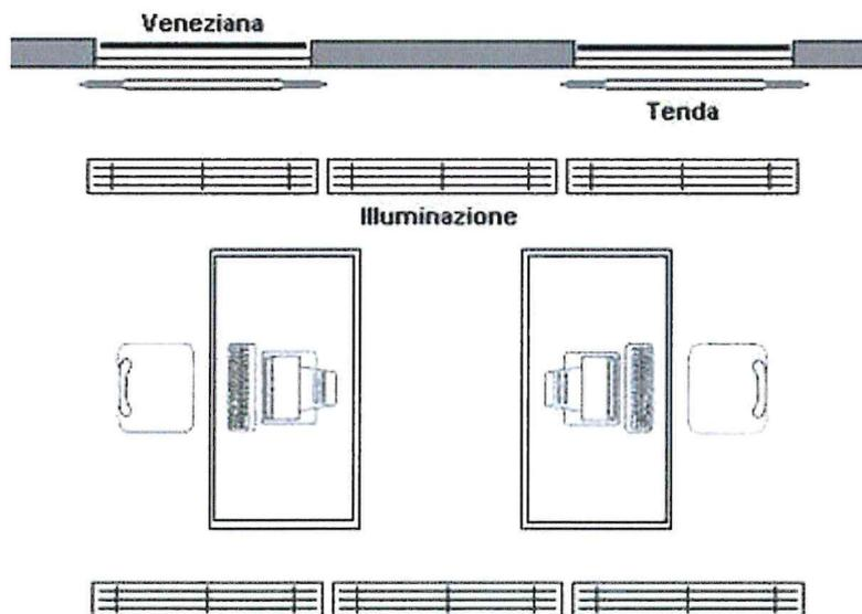
L' **illuminazione artificiale** dell'ambiente deve essere realizzata con lampade a tonalità calda provviste di schermi antiriflesso ed esenti da sfarfallio.
