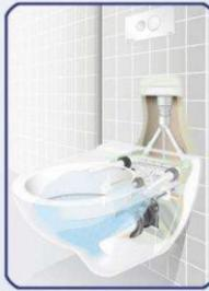
DISTRIBUZIONE DEL FLUSSO TRAMITE 3 INGRESSI: OLTRE ALLO SCIACQUO PRINCIPALE, L'ACQUA VIENE CONVOGLIATA ANCHE PARALLELAMEN- TE, A SINISTRA E DESTRA DELLA PARETE ANTERIORE, IN MODO TALE DA ASSICURARE IL PASSAGGIO PER UN ECCELLENTE RISULTATO DI SCARICO. CONSUMA 3,5 LITRI DI ACQUA E CONSENTE DI RISPARMIARE FINO AL 40% DI ACQUA IN PIU' RISPETTO AI TRADIZIONALI WC DA 6 LITRI. UNICA CONDIZIONE PER L'INSTALLAZIONE E' CHE LO SCARICO SIA REALIZZATO IN CONFORMITA' CON LO STANDARD EUROPEO EN 12056.
