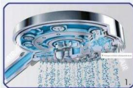
ECO SMART TECNOLOGIA IN GRADO DI REGOLARE LA QUANTITA' DI ACQUA: L'ANELLO TORICO REAGISCE IN MANIERA FLESSIBILE ALLA PRESSIONE DELL'ACQUA, MANTENENDO COSTANTEMENTE BASSO IL SUO FLUSSO. IN CASO DI PRESSIONE ELEVATA, L'ANELLO RIDUCE L'APERTURA DI FUORIUSCITA, ALLARGANDOLA DI CONSEGUENZA QUANDO INVECE LA PRESSIONE DIVENTA MINIMA. (2.-3.)
