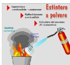
Costituite da **particelle solide finissime** a base di bicarbonato di sodio, potassio, fosfati e sali organici.
